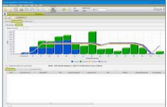
**MES** | Il sistema di pianificazione della produzione raccoglie i dati base dall'ERP, vengono quindi integrati i dettagli di pianificazione come l'assegnazione delle macchine e i tempi standard.
