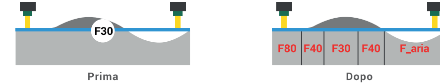
Ottimizzazione velocità di avanzamento (F)
